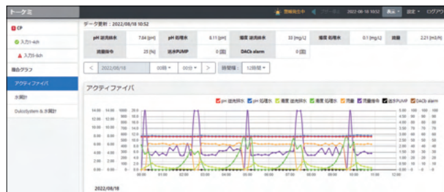
■繊維ろ過装置 濁度 / pH / 流量監視
