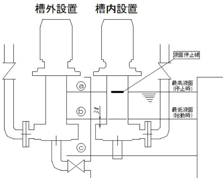
④ 槽内の最高液面(停止時)は、ポンプボデーに表示している『液面停止線』以下として下さい。
