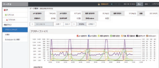
■ 繊維ろ過装置 濁度/pH/流量監視
