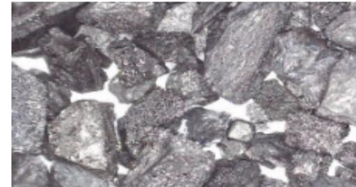
石炭を原料とした活性炭です。細孔径が大きいマクロポアが発達しており、カビ臭の原因物質であるジェオスミンやトリハロメタン前駆物質であるフミン質等のような比較的分子量の大きな有機物の除去に適しています。活性炭に生物を担持させる生物活性炭処理にも用いられています。
